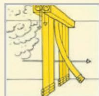
Автоматическая дымозащитная штора, опускаемая до пола, оставляющая возможность прохода через неё
