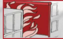
Между зданиями должно соблюдаться минимальное расстояние от 3 до 5 м. При меньших расстояниях соседние стены должны быть огнестойкими. Светопроницаемые проёмы нужно соответствующим образом перекрыть огнестойким материалом, чтобы обеспечить защиту от переброски пламени. Как можно это осуществить если запланированы открывающиеся окна?
