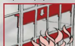
Текстильная огнезащитная преграда как конструктивный элемент для предотвращения переброски пламени с одного этажа на другой.
