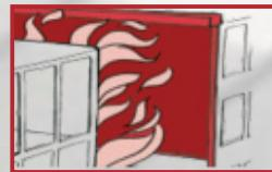
Starp ēkām ir jāievēro minimālais attālums no 3m līdz 5m. Ja attālums ir mazāks, tad ēkas sānu sienām ir jābūt ugunsdrošām. Gaismas caurlaidīgās aillas nepieciešams pārkāpt ar atbilstošu ugunsdrošu materiālu, lai nodrošinātos pret liesmā pārnešanu. Kā to ir iespējams īstenot, ja ir ieplānoti atverami logi?
